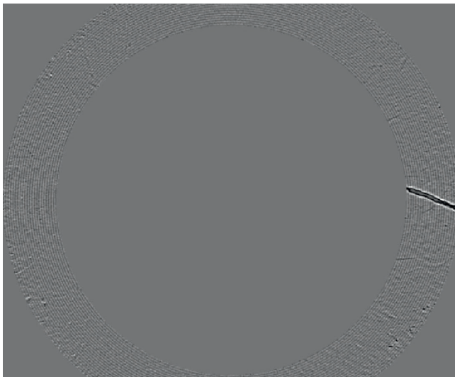
Bild 4. Beispiel für ein mit dem Verfahren „Shape from Shading“ erstelltes Prüfbild. © Kistler
